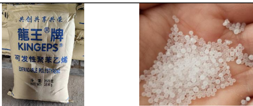
图 2-1 项目使用的可发性聚苯乙烯（EPS）外观
