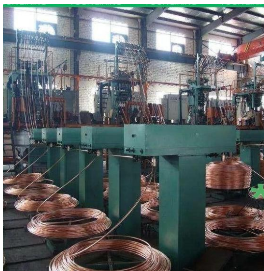
上引收线机和产出的无氧铜杆
