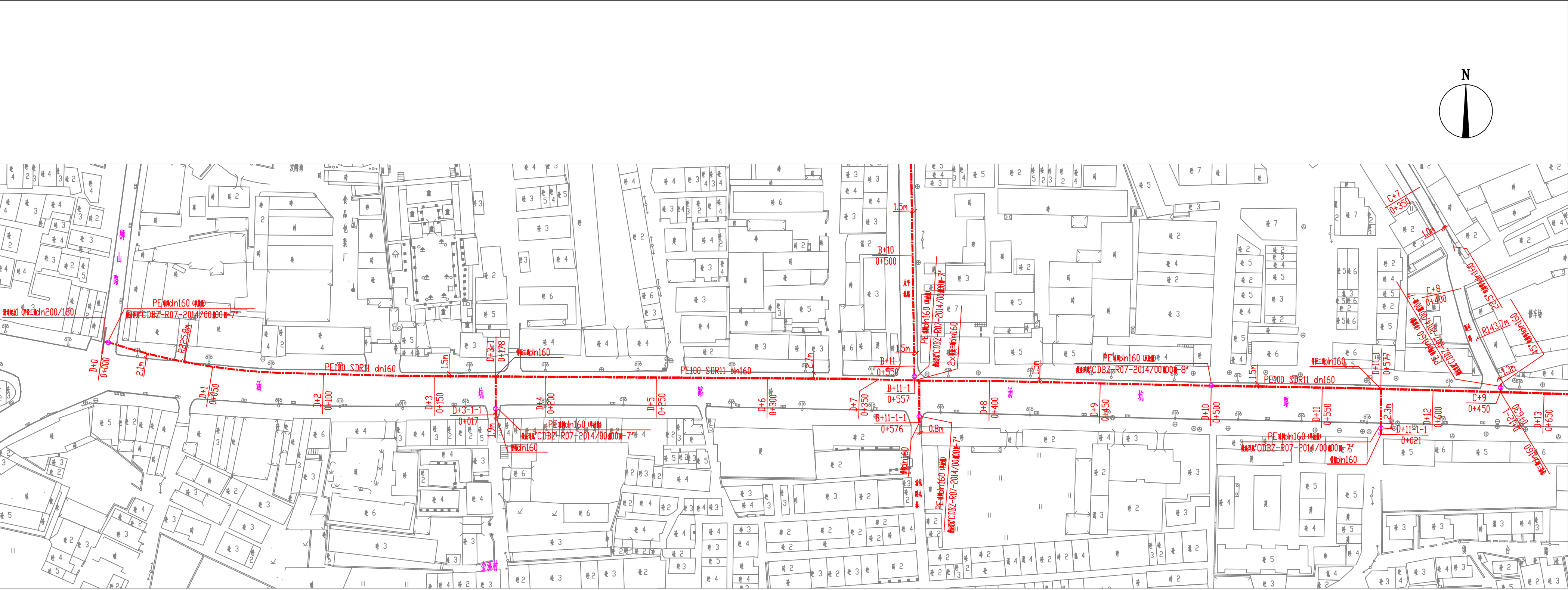
中压燃气管道平面布置图（一） 1:1000
