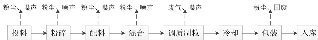
图2 现有项目颗粒鱼料生产线生产工艺及污染源图
